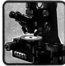
3. Une combinaison de plusieurs couches minces déposées sous vide améliore la résolution des microscopes de recherche
